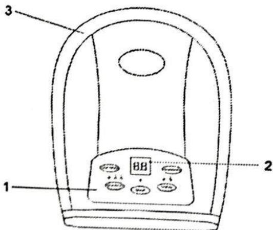
1. Панель управления (время, давление воздуха, включение / выключение обогрева, декомпрессия)
